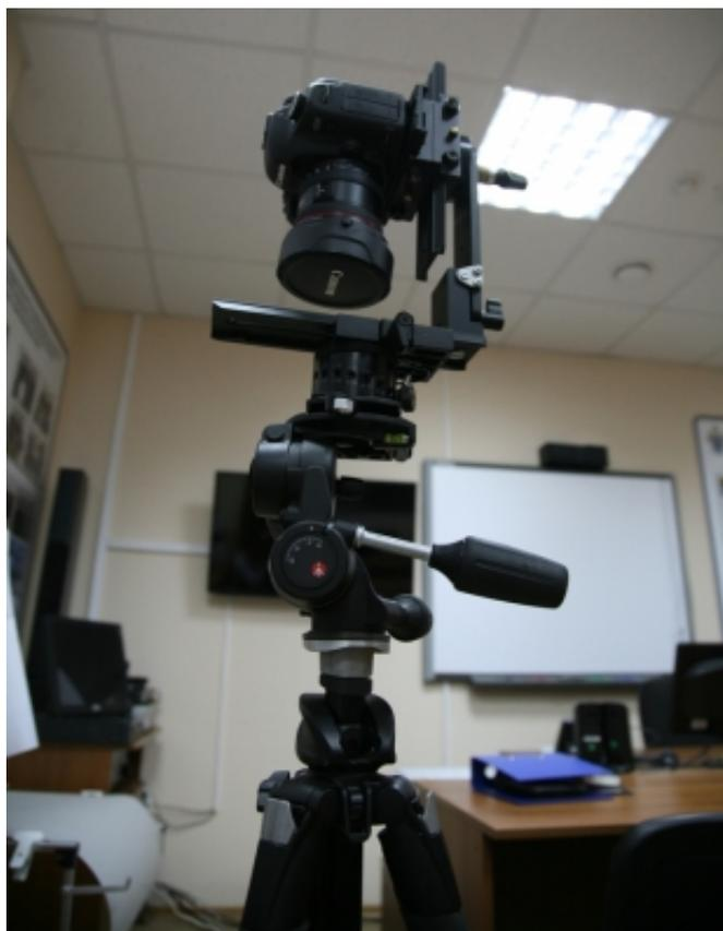
Цифровой фотоаппарат со сверхширокоугольным объективом (рыбий глаз) применяется следователем, следователем-криминалистом в ходе осмотра места происшествия с целью создания панорамных и объемных (3-D) фотографий.
